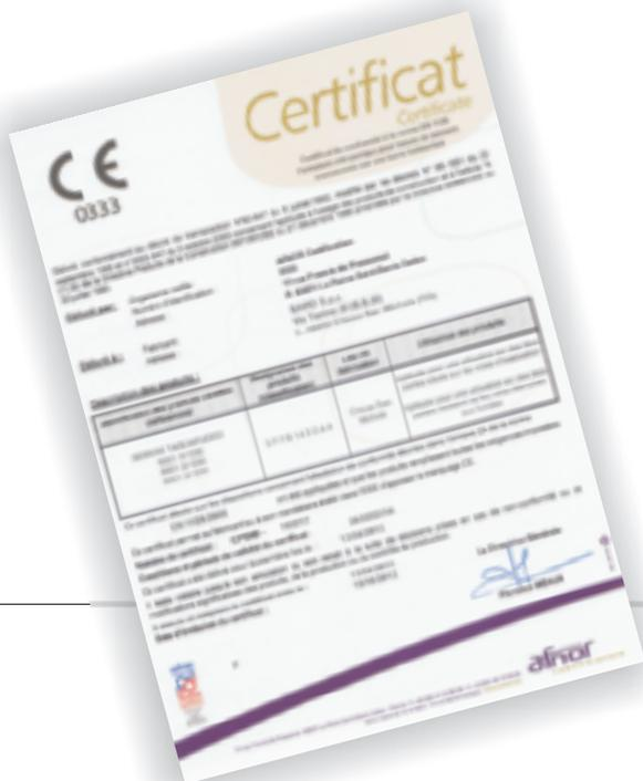
Pour mémoire, la norme EN 1125 certifie les fermetures applicables jusqu'aux dimensions de vantail maximum suivantes: largeur 1300 mm et hauteur 2500 mm. Pour les portes avec dimensions supérieures, la fermeture ne peut être certifiée (6000.B/1500, 6000.721). Pour les applications avec des dimensions supérieures, qui ne sont pas comprises dans le domaine de la certification, des essais volontaires ont été effectués auprès du laboratoire français CETIM.
