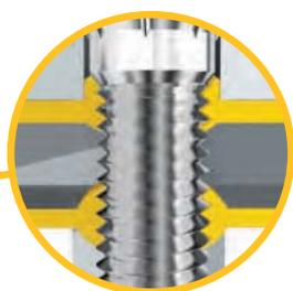
**Record di solidità del fissaggio.** La particolare sagoma a punta rastremata di Fixia permette un fissaggio molto solido al profilo, perché aumenta lo spessore di presa della filettatura. Infatti durante l'inserimento la vite allarga gradualmente il foro e raddoppia lo spessore del profilo in corrispondenza della filettatura stessa. Questa operazione, detta rifollatura, consente un fissaggio solido e duraturo.
