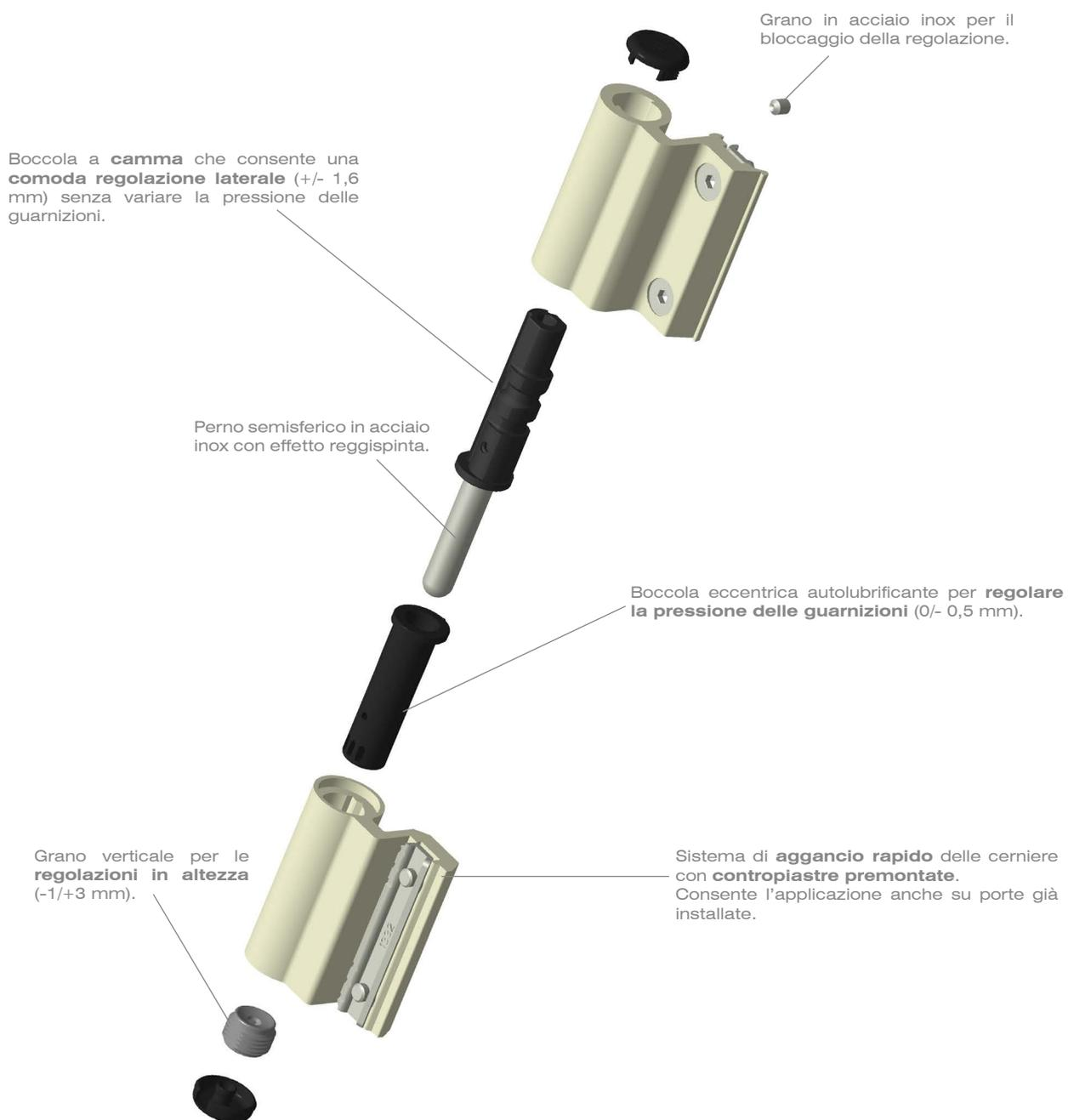
Contropiastre in **acciaio inox** per una migliore **resistenza alla corrosione** e un più **solido fissaggio** nel tempo.
