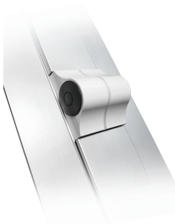
PIVOTY è una nuova linea di cerniere a frizione applicabile ad ogni tipo di finestra a bilico. Con solo pochi modelli si coprono tutte le principali serie di profili, con portate da 80 Kg (bilico verticale) a 120 Kg (bilico orizzontale e verticale) e fino a 150 Kg aggiungendo il rinforzo art. 1152.701 (solo bilico orizzontale). Le qualità: versatilità, robustezza e montaggio molto semplice. In più, PIVOTY è utilizzabile con la nuova chiusura perimetrale.
