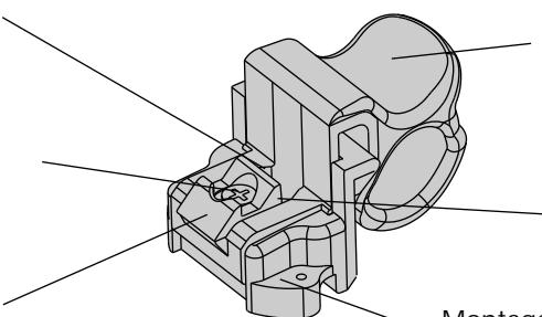
Corp en métal injecté et poignée en nylon, confortable et ergonomique.
