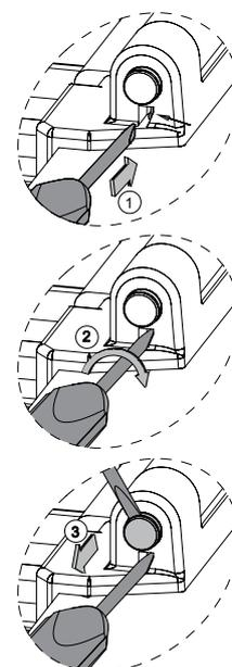
N.B.: les paumelles pour le vantail associé réf. 3150.830 gardent le blocage de l'axe en utilisant la vis-pointeau.
