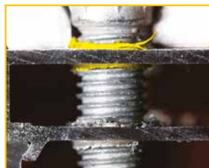
Le profil est comprimé contre le trou de la paumelle et forme une collerette qui élimine les jeux vis/paumelle/profil.
