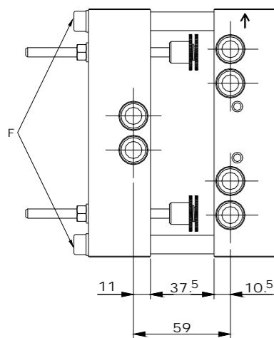
(3) Montaggio d'una interasse 59 mm.
