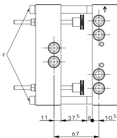
(4) Montaggio d'una interasse 67 mm.
