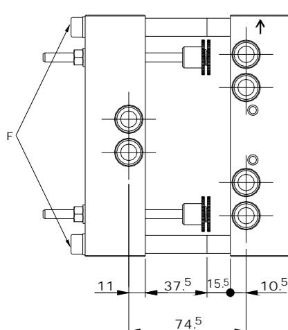
(5) Montaggio d'una interasse 74.5 mm.
