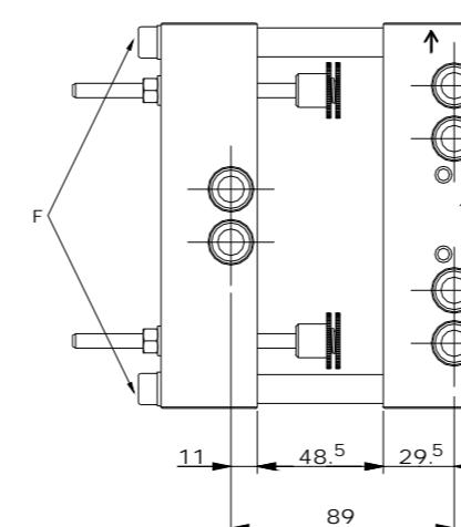
(8) Montaggio d'una interasse 89 mm.
