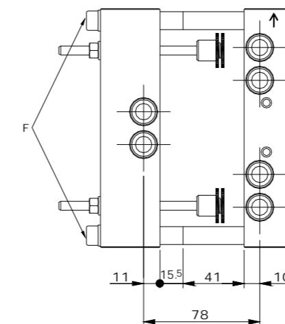
(6) Montaggio d'una interasse 78 mm.
