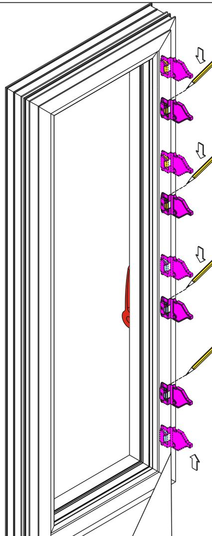
Chiudere l'anta, spostare la dima nel senso della freccia fino al suo fermo e segnare la posizione sul telaio.
