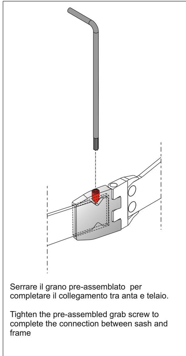
Serrare il grano pre-assemblato per completare il collegamento tra anta e telaio.
