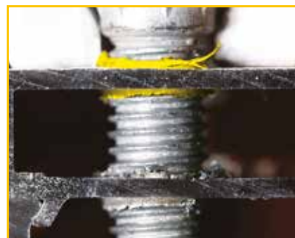
El perfil es comprimido contra el agujero de la bisagra formando un collar que elimina los juegos tornillo/bisagra/perfil.
