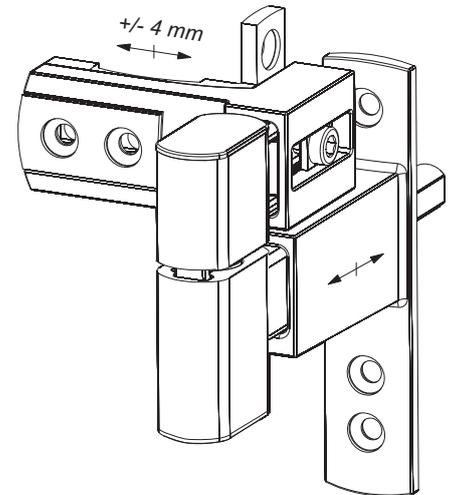
Cerniera con campo di registrazione laterale +/- 4 mm
